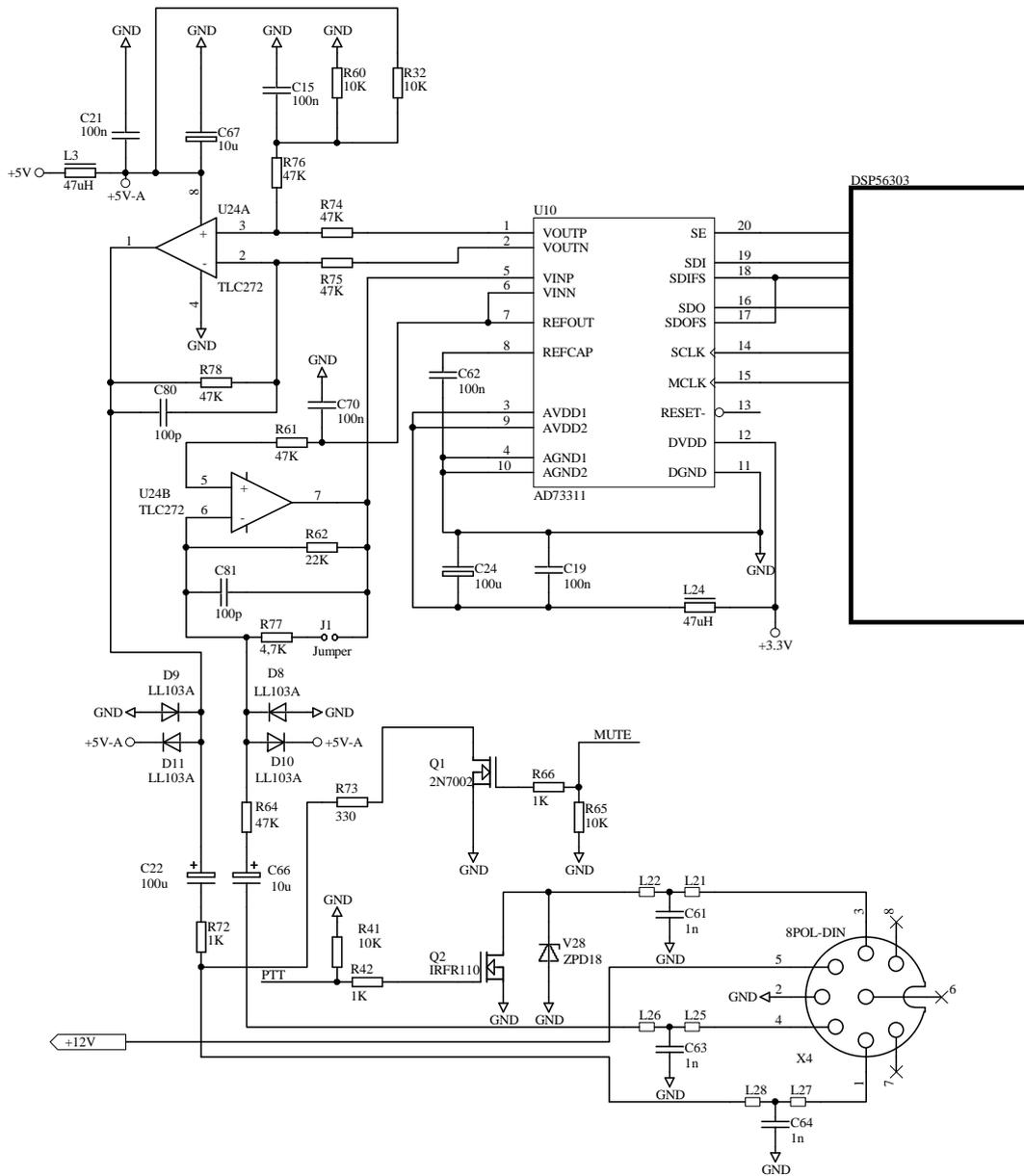
Abbildung D.3: HF-Transceiver Audio
