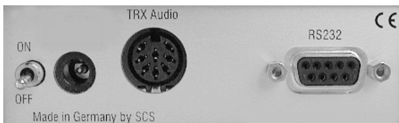
Abbildung 3.1: Rückwand des PTC-IIex
