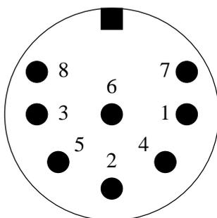
Pin 1: Audio-Ausgang vom PTC zum Funkgerät.
