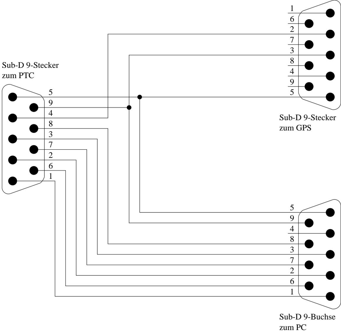
Abbildung D.4: RS232 Y-Kabel
