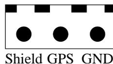
Abbildung 5.1: GPS Anschluß
