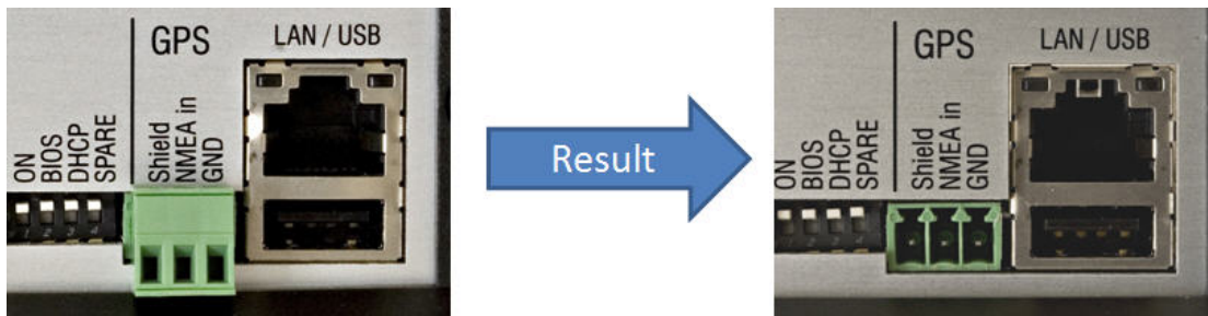
Abbildung 2: Entfernen der Schraubklemmen am Beispiel des DR-7800
