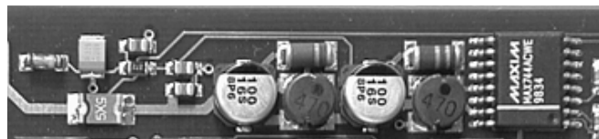
Abbildung 14.4: Das PTC-IIe Schaltnetzteil
