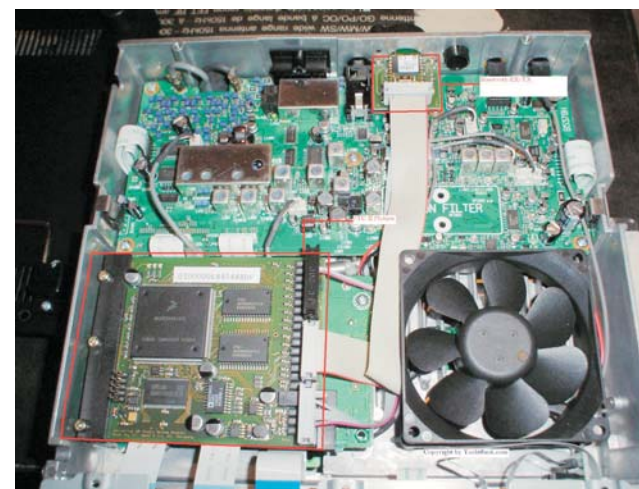
Typischer Einbau. Hier in einem ICOM 78 Kurzwellenfunkgerät durch yachtfunk.com
